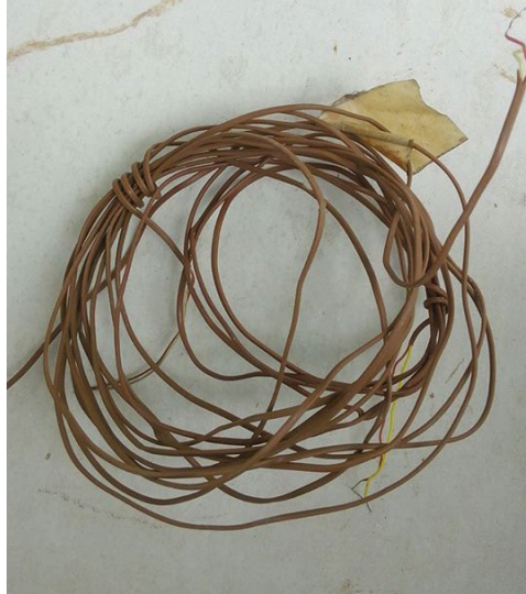
ภาพที่ 3.19 สายเทอร์โมคัปเปิ้ลชนิด K
