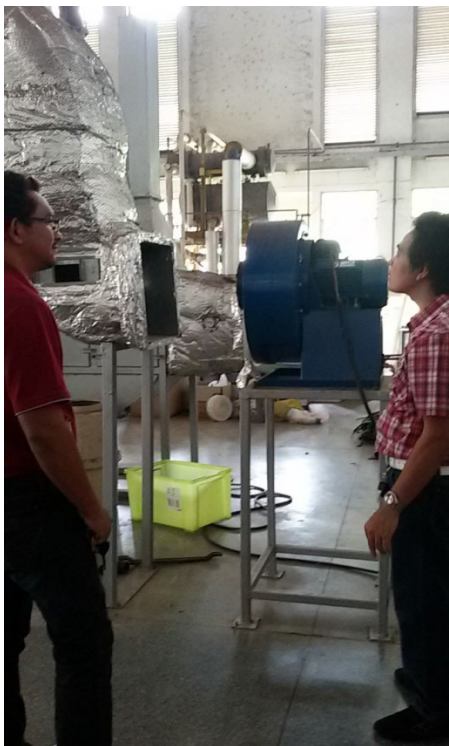
รูปที่ 4.9 พัดลมดูดอากาศดูดความร้อนเข้ามาไหลผ่านท่อทำให้มีอุณหภูมิเพิ่มขึ้น (ที่มา: สุนันทศักดิ์ ระวังวงศ์, 2558)
