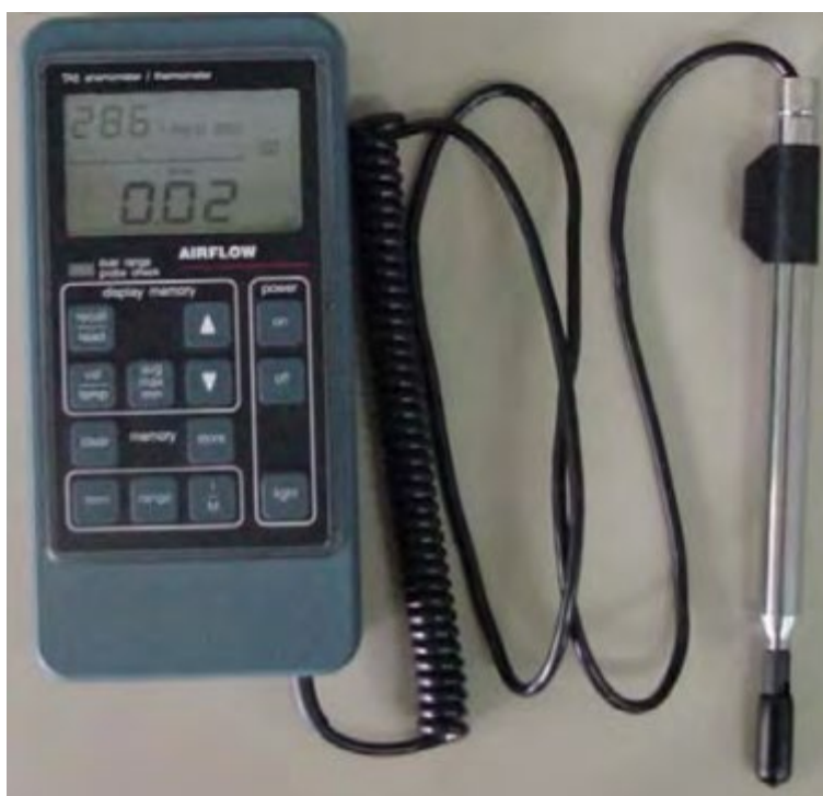
รูปที่ 3.7 เครื่องวัดอัตราการไหลของอากาศแบบฮอตไวร์ (ที่มา: สุนันทศักดิ์ ระวังวงศ์, 2558)
