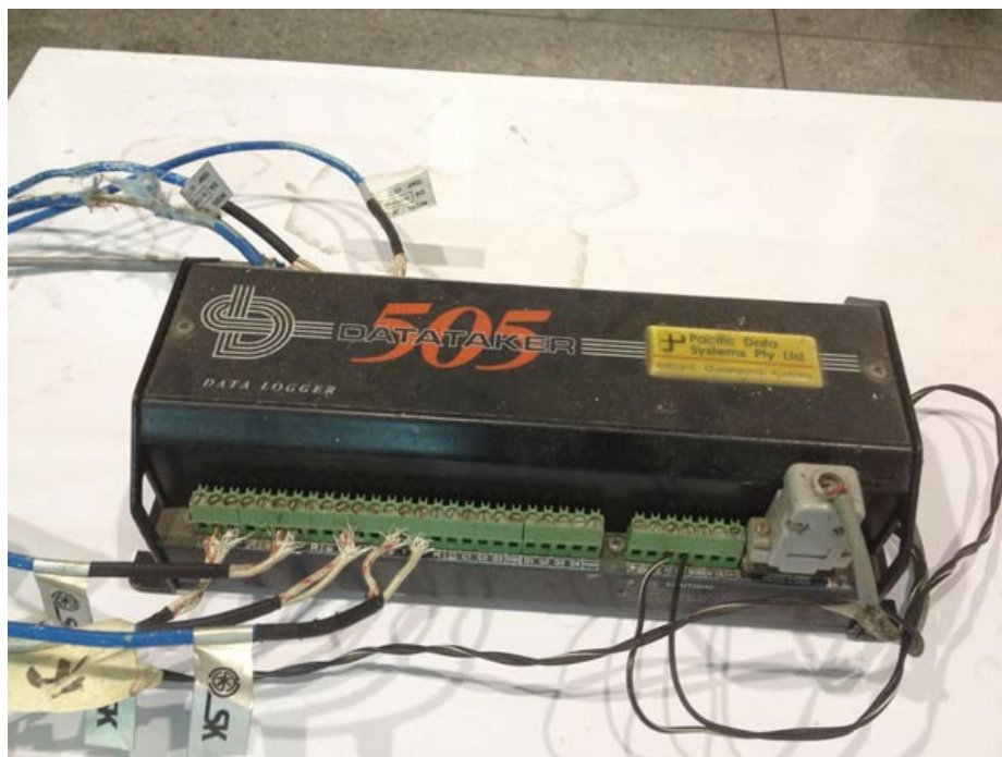
รูปที่ 3.8 เครื่องบันทึกข้อมูล (data logger) ยี่ห้อ DATATAKER รุ่น 505 (ที่มา: สุนันทศักดิ์ ระวีวงศ์, 2558)
