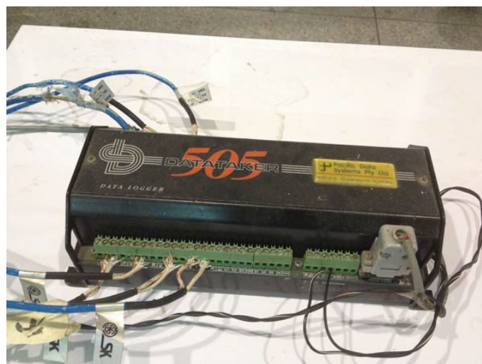
รูปที่ 4.15 สายเทอร์โมคัปเปิลเปิดต่อกับ Data Logger (ที่มา: สุนันทศักดิ์ ระวังวงศ์, 2558)
