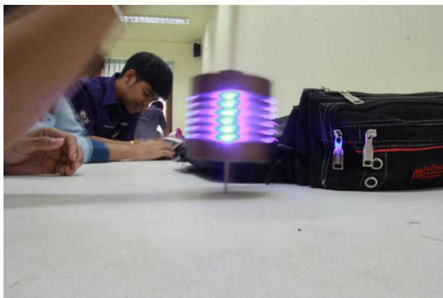
ภาพที่ 3.18 ทดสอบการแสดงผลบนจอแอลอีดี
