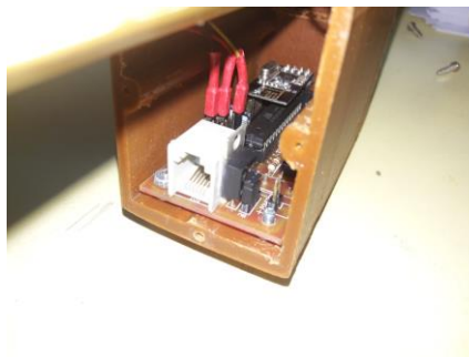
ภาพที่ 3.35 บอร์ดควบคุม
