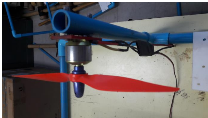
ภาพที่ 3.45 มอเตอร์และใบพัดสำหรับกำเนิดลมทดสอบ
