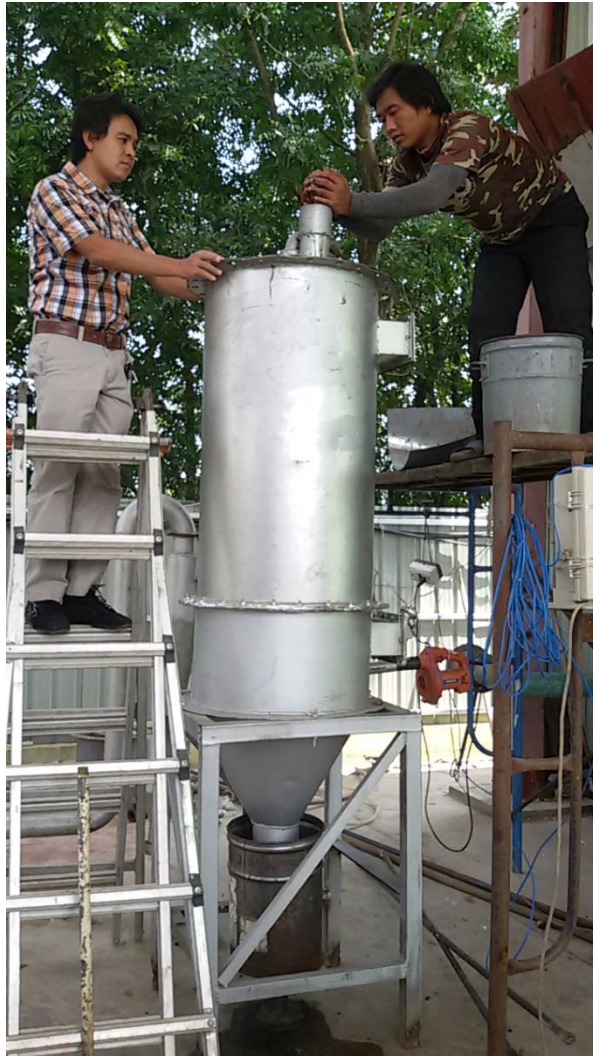
รูปที่ 3.16 การบรรจุเชื้อเพลิงเข้าระบบเตาแก๊สซีฟิเออร์
