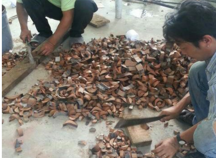
รูปที่ 3.9 ตัวอย่างวัสดุจากทางตาลโตนดที่ถูกตัดให้เหมาะสมกับการทดสอบ
