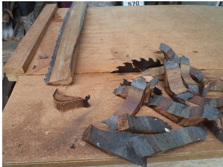
รูปที่ 3.8 ตัวอย่างวัสดุจากทางตาลโตนดที่ถูกตัดให้ชิ้นเล็กลงโดยเครื่องจักร
