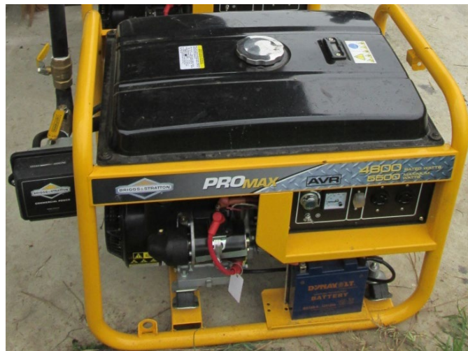
รูปที่ 3.13 อุปกรณ์ประกอบระบบผลิตไฟฟ้าด้วยเครื่องยนต์ชีวมวล: เครื่องยนต์พร้อมเครื่องปั่นไฟฟ้า
