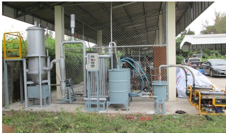
รูปที่ 3.15 ระบบเตาแก๊สซีฟิเออร์ชนิดเบตคองที่เปลวไฟไหลลง
