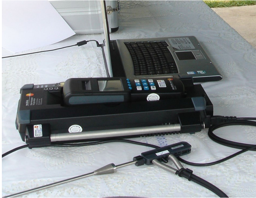
รูปที่ 3.19 เครื่องวิเคราะห์ก๊าซไอเสียและคอมพิวเตอร์โน้ตบุ๊ก
