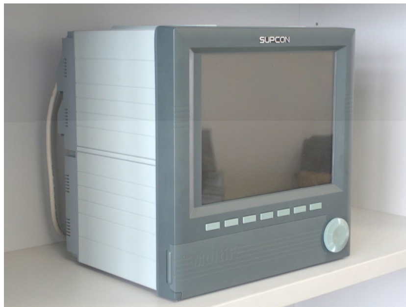
รูปที่ 3.18 อุปกรณ์บันทึกข้อมูลอัตโนมัติขนาด 16 ช่องสัญญาณ
