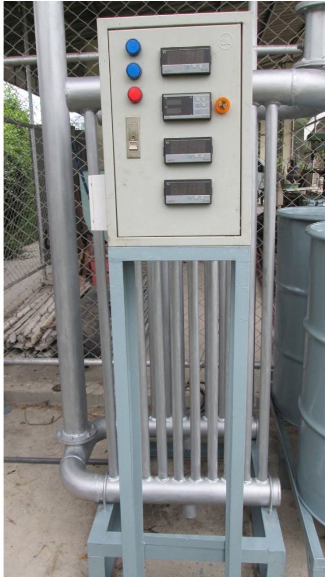
รูปที่ 3.9 อุปกรณ์ประกอบระบบผลิตไฟฟ้าด้วยเครื่องยนต์ชีวมวล: ชุดควบคุมอุณหภูมิ
