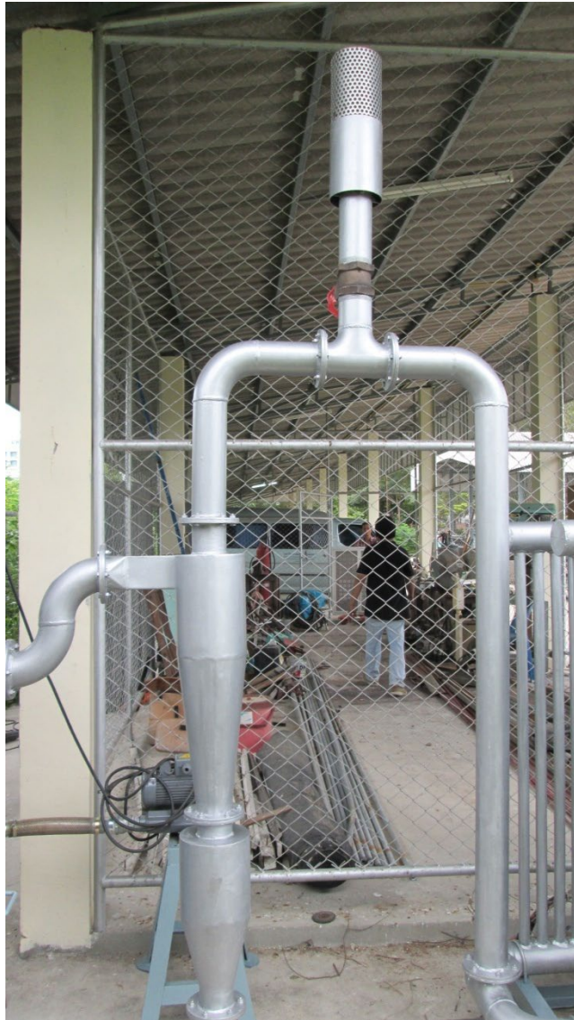
รูปที่ 3.7 อุปกรณ์ประกอบระบบผลิตไฟฟ้าด้วยเครื่องยนต์ชีวมวล: ไชโคลอน
