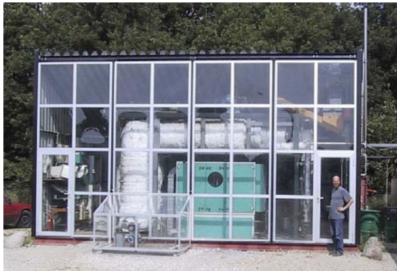
รูปที่ 2.27 ระบบผลิตแก๊สซิฟิเคชันขนาด 75 kW
