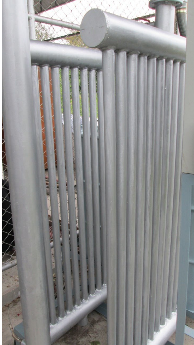
รูปที่ 3.8 อุปกรณ์ประกอบระบบผลิตไฟฟ้าด้วยเครื่องย่นไส้ขั้วมวล: ชุดลดอุณหภูมิแก๊ส
