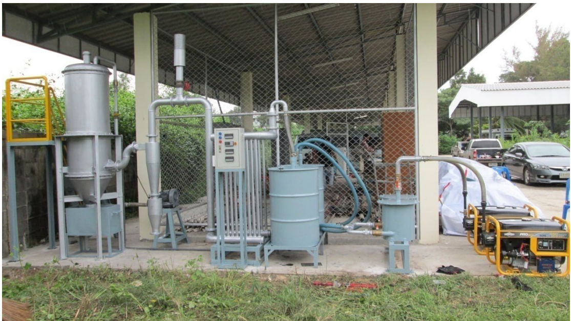
รูปที่ 3.17 ระบบเตาแก๊สซีฟเออร์ชนิดเบดคงที่เปลวไฟไหลลง
