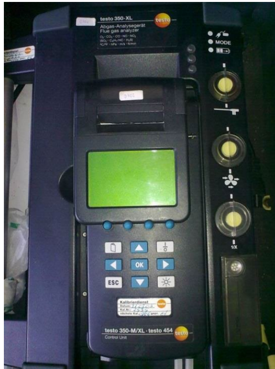
รูปที่ 4.3 แสดงเครื่องวัดองค์ประกอบแก๊ส (Gas analyzer)
