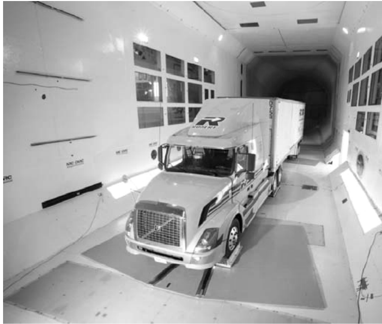
ภาพที่ 2.25 การทดสอบโดยใช้อุโมงค์ลมขนาดใหญ่ (Leuschen and Cooper, 2006)
