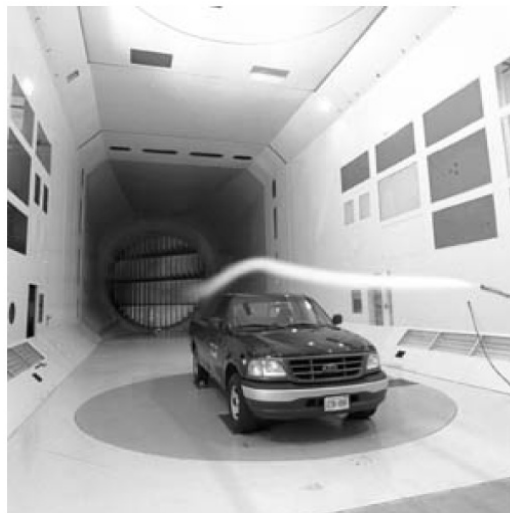
ภาพที่ 2.1 การทดสอบรถบรรทุกเล็กจริงในอุโมงค์ลมของ NRC
