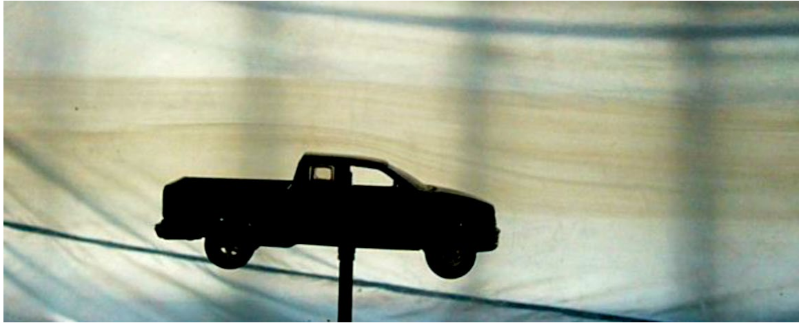
ภาพที่ 3.2 เส้นทางการไหลของอากาศที่ไหลผ่านแบบจำลองรถบรรทุกเล็ก ทดสอบในอุโมงค์ลม ที่ความเร็ว 10 m/s
