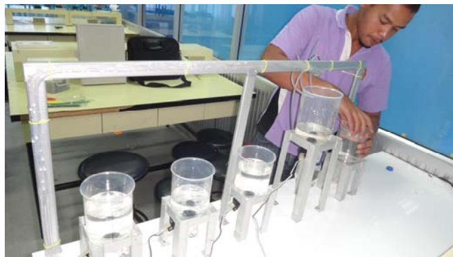
ภาพที่ 4.29 การทดสอบการทำงานของระบบควบคุมในการสูบน้ำเข้าถัง
