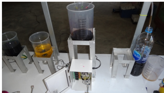
ภาพที่ 4.97 กล่องควบคุมระบบการสูบน้ำเข้าถัง
