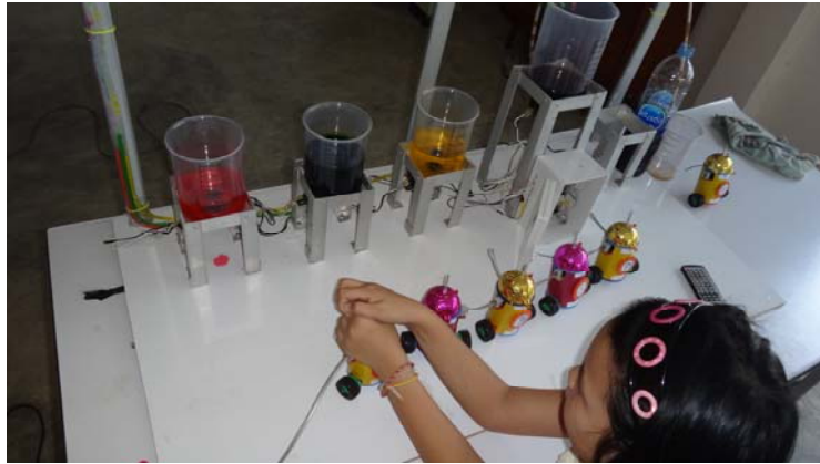
ภาพที่ 4.27 การ โปรแกรมชุดคำสั่งโดยบังแสงที่มีความสว่างมาก
