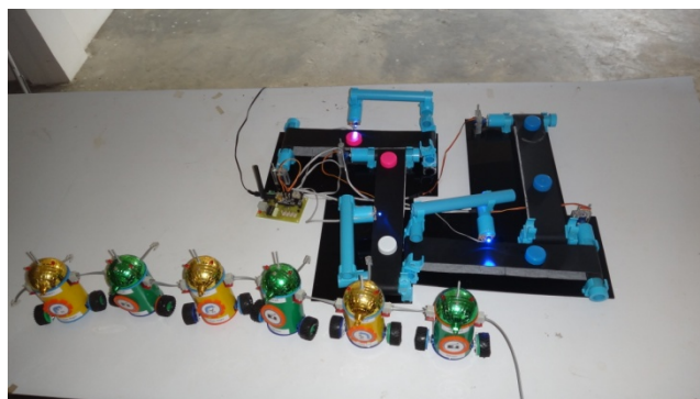
ภาพที่ 4.105 สายพานลำเลียงควบคุมด้วยโปรแกรมที่สัมผัสและรู้สึกรู้ได้ 3 คำสั่ง
