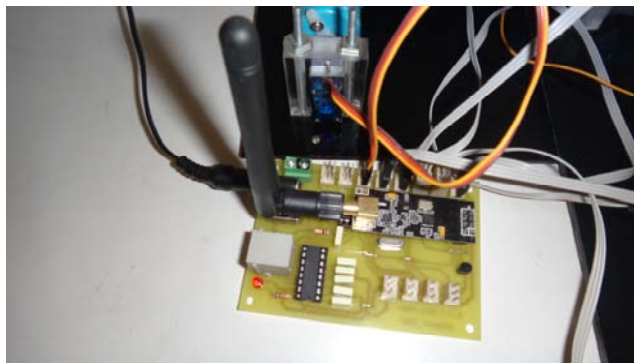
ภาพที่ 4.34 บอร์ดควบคุมระบบสายพาน
