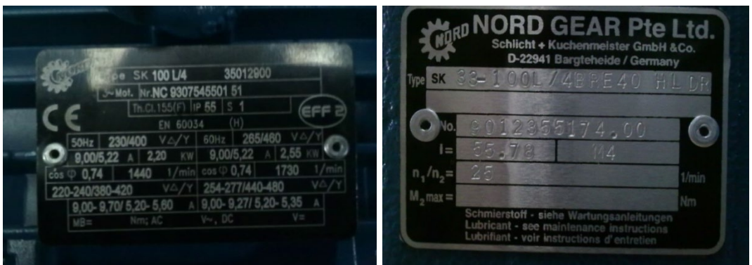
รูปที่ 4-4 nameplate motorgear
