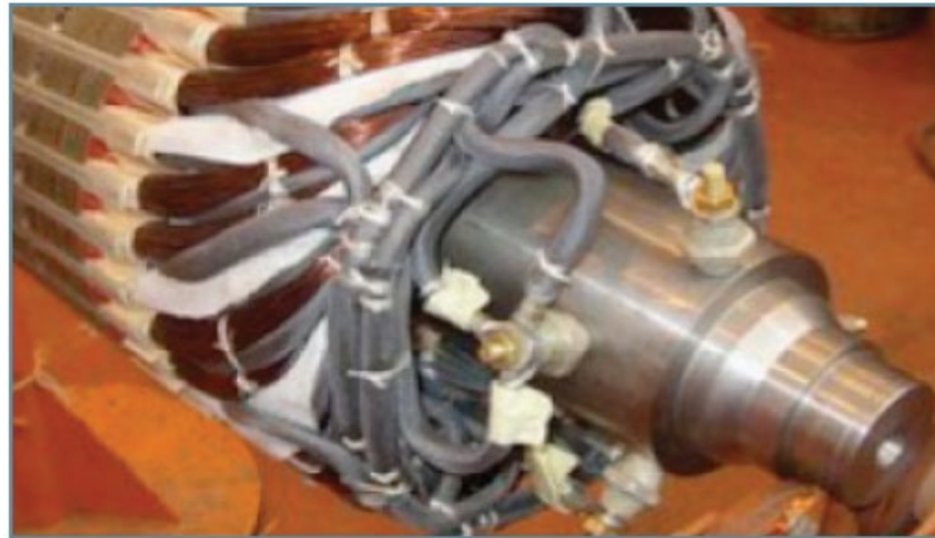
รูปที่ 2.6 โรเตอร์ของเครื่องจักรกลไฟฟ้าเหนี่ยวนำแบบพันขดลวด ที่มา: นิตยสารธุรกิจไฟฟ้า เครื่องกล อิเล็กทรอนิกส์ เทคโนโลยีและสิ่งแวดล้อม ปีที่ 20 ฉบับที่ 1 ประจำเดือน พฤษภาคม-กรกฎาคม 2556
