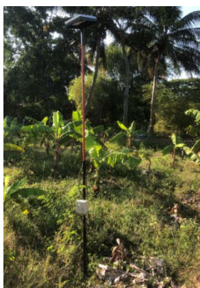
ภาพที่ 8 การวางอุปกรณ์เซ็นเซอร์เพื่อวัดความชื้นในดิน สำหรับการปลูกกล้วยหอมทอง
