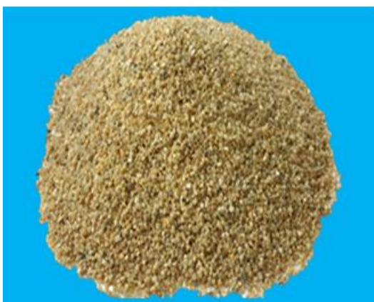
ภาพที่ 3.5 ทรายซิลิกาที่ใช้เป็นวัสดุเบดในการทดสอบการเผาไหม้
