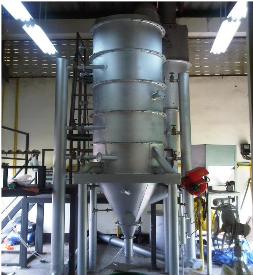
ภาพที่ 3.1 เตาเผาฟลูอิด์เบดแบบทรงกรวยขนาด ก่อนการปรับปรุงเพื่อใช้สำหรับการเผาไหม้ร่วม
