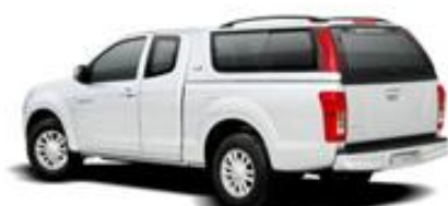
หลังคาครอบกระบะ
