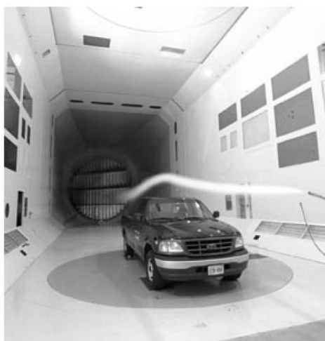
ภาพที่ 2.23 การทดสอบรถบรรทุกเล็กจริงในอุโมงค์ลมของ NRC
