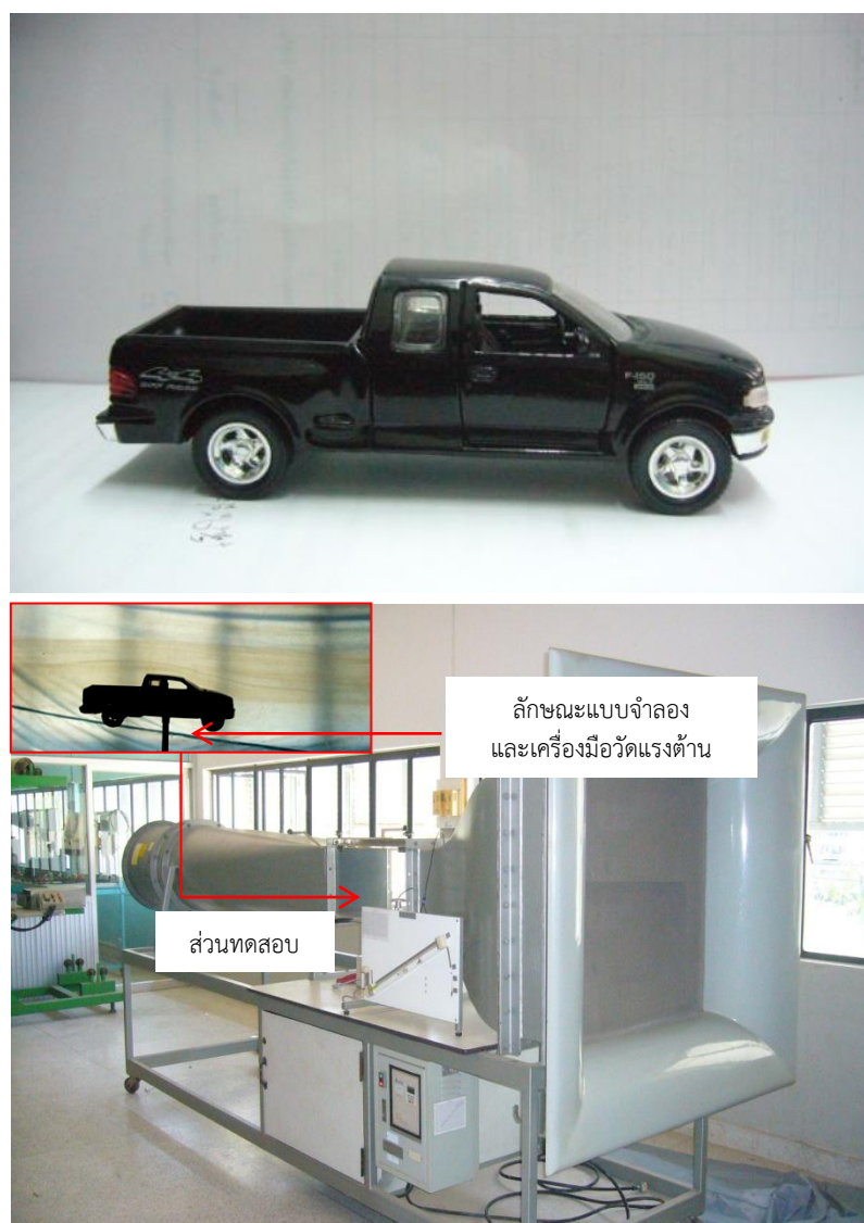
ภาพที่ 3.6 แบบจำลองรถกระบะที่ใช้ทดสอบในอุโมงค์ลม
