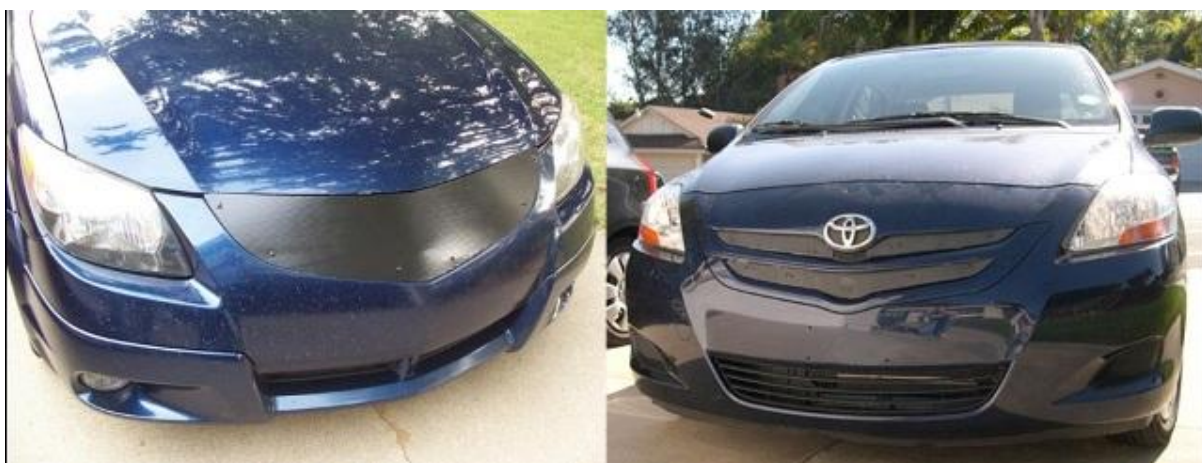
รูปที่ 2.6 อุปกรณ์ปิดช่องลมด้านหน้ารถ (Grille block)
