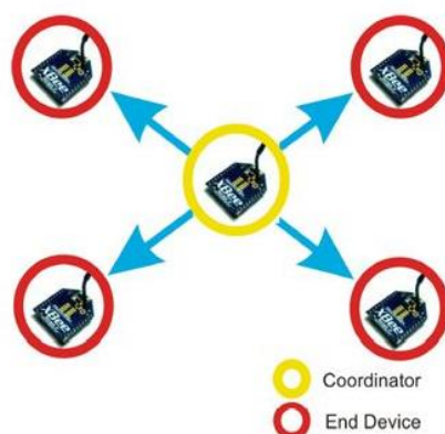
ภาพที่ 2.12 แสดงรูปแบบการเชื่อมต่อแบบ Star
