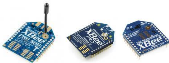
ภาพที่ 2.9 ภาพอุปกรณ์ประเภทของเสาอากาศ 3 แบบ
