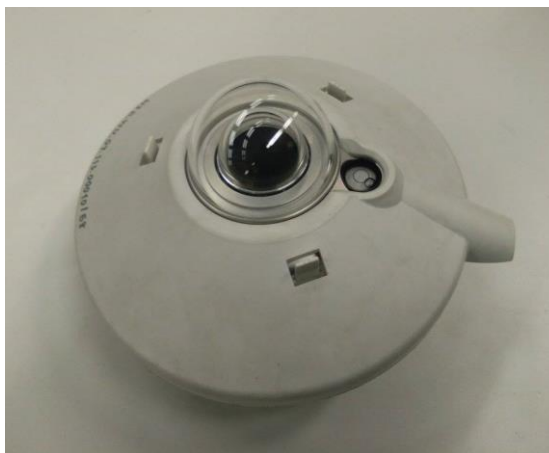
ภาพที่ 3.12 ไพรานอมิเตอร์ใช้วัดค่ารังสีอาทิตย์
