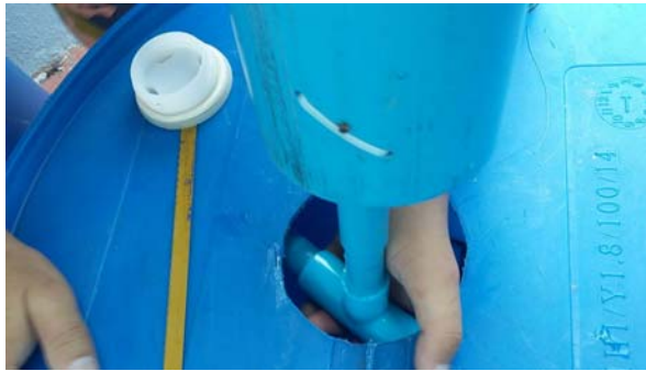
ภาพที่ 3.14 การประกอบใบกวนเข้ากับแกน
