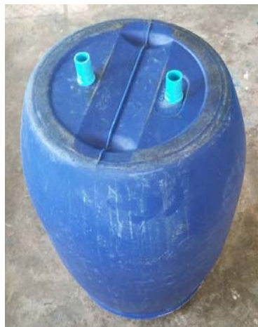
ภาพที่ 3.18 การประกอบถังเก็บก๊าซชีวภาพ
