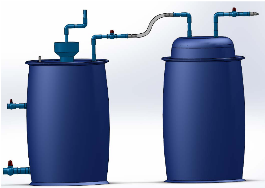
ภาพที่ 3.10 แบบระบบผลิตก๊าซชีวภาพภายใต้สภาวะไร้ออกซิเจนแบบฝาครอบแช่ในบ่อมูล 3 มิติ
