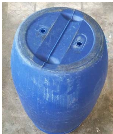
ภาพที่ 3.17 ตำแหน่งจุดเจาะของถังเก็บก๊าซชีวภาพ
