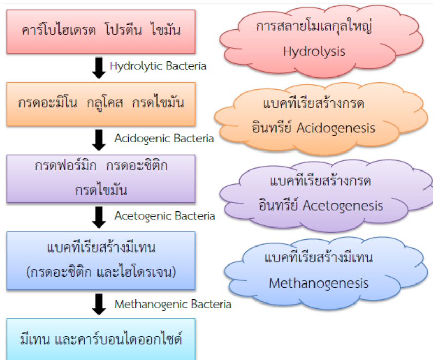
ภาพที่ 2.6 สรุปขั้นตอนอย่างง่ายในการเปลี่ยนสารอินทรีย์ให้เป็นก๊าซชีวภาพ
