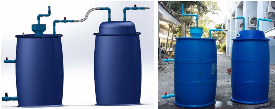
ภาพที่ 4.2 ระบบจากการออกแบบของระบบผลิตก๊าซชีวภาพที่สร้างขึ้น
