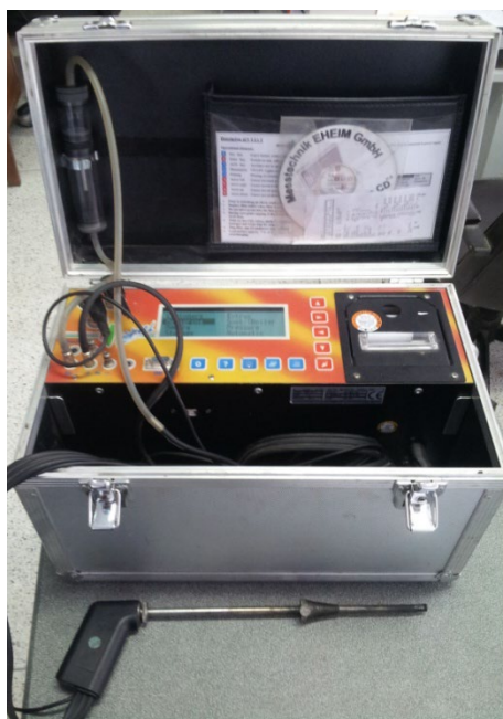
ภาพที่ 3.10 เครื่องวิเคราะห์สมรรถนะหม้อน้ำ และอุปกรณ์อุ่นน้ำป้อน
